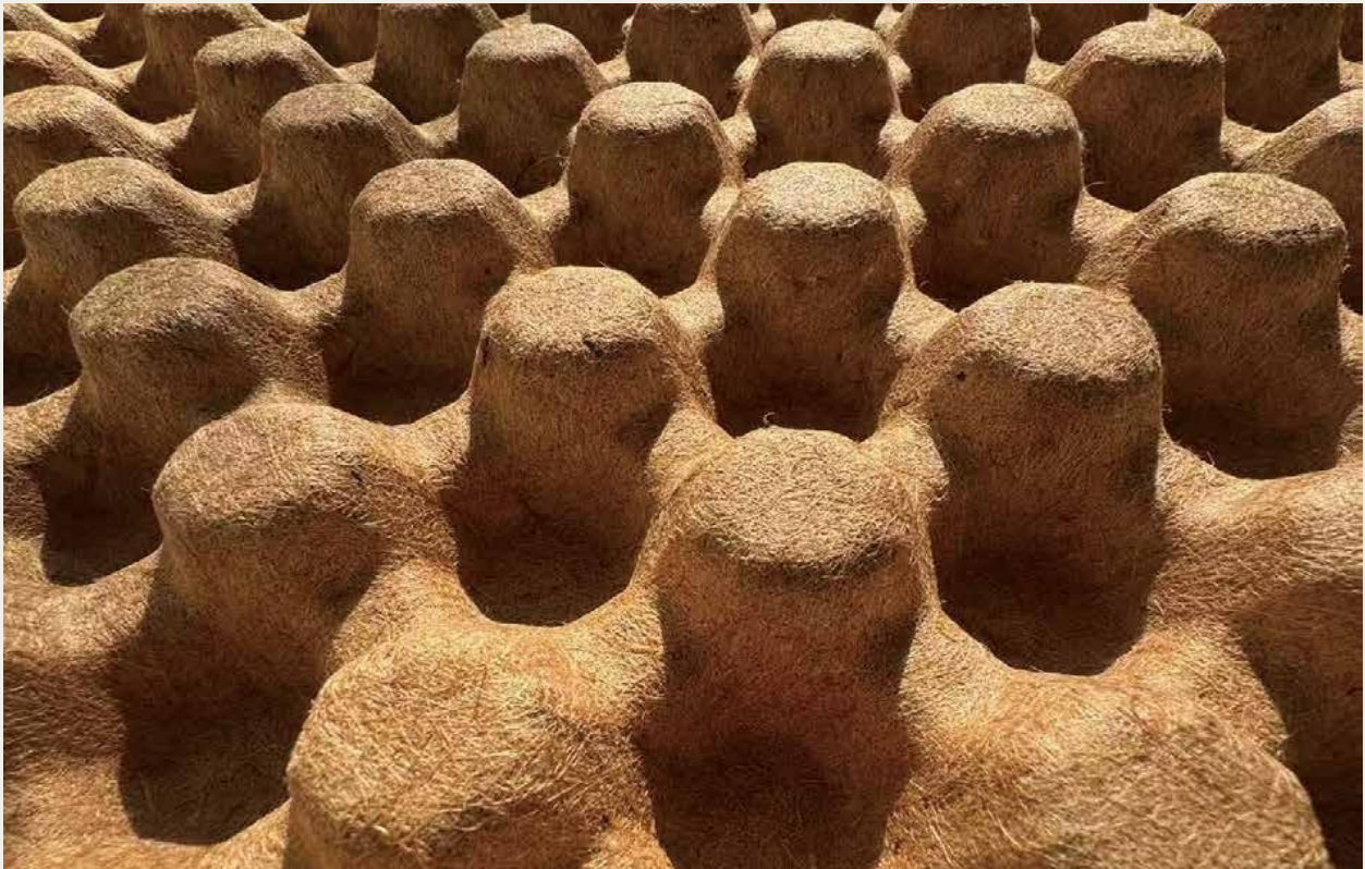
上：芯材の量産ライン。下：成形後の自然繊維芯材。 いずれも独自金型による熱圧成形工程で製造されます。
